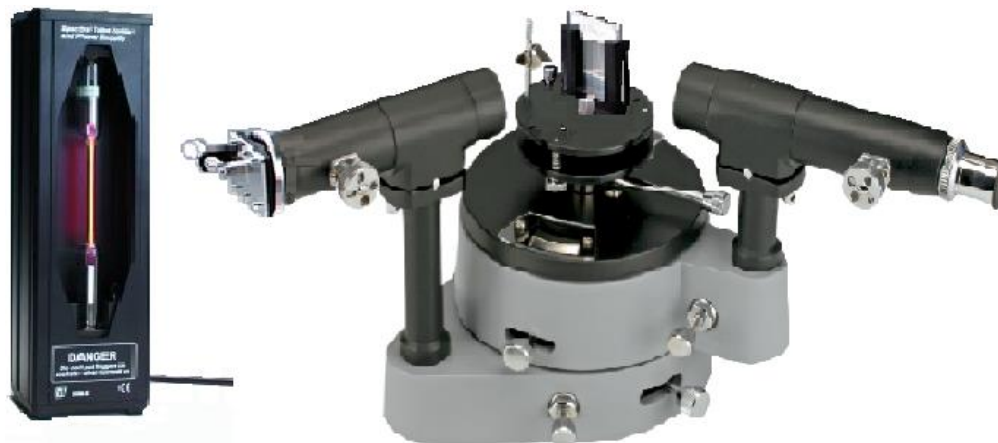
Rys. 1 (na podstawie [5]) a). Spektrometr firmy Frederiksen z siatką dyfrakcyjną (obok widoczny uchwyt pryzmatu) i z uchwytem zasilającym.
