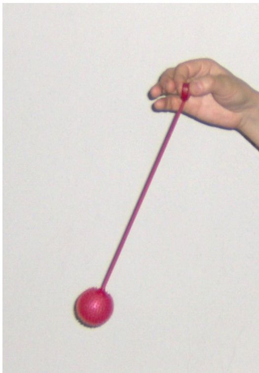
Fot. 12. Elastyczna kula wodna, jako wahadło o zmiennej długości.
