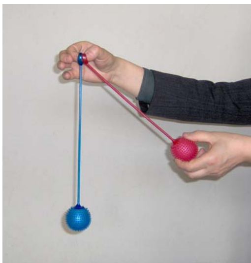
Fot. 9. Przygotowanie elastycznych kul wodnych do pokazu zderzenia ciał częściowo sprężystych.
