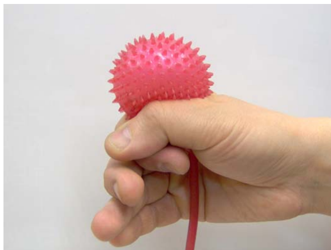
Fot. 18. Sposób zaciśnięcia elastycznej kuli wodnej do pokazu prawa Pascala.
