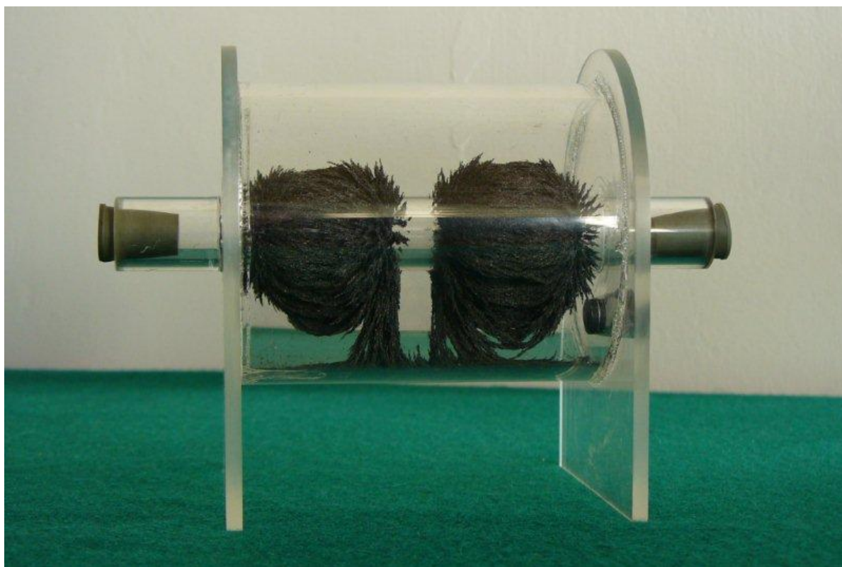
Fot. 1. Magnesy w rurkach są zwrócone do siebie tymi samymi biegunami.
