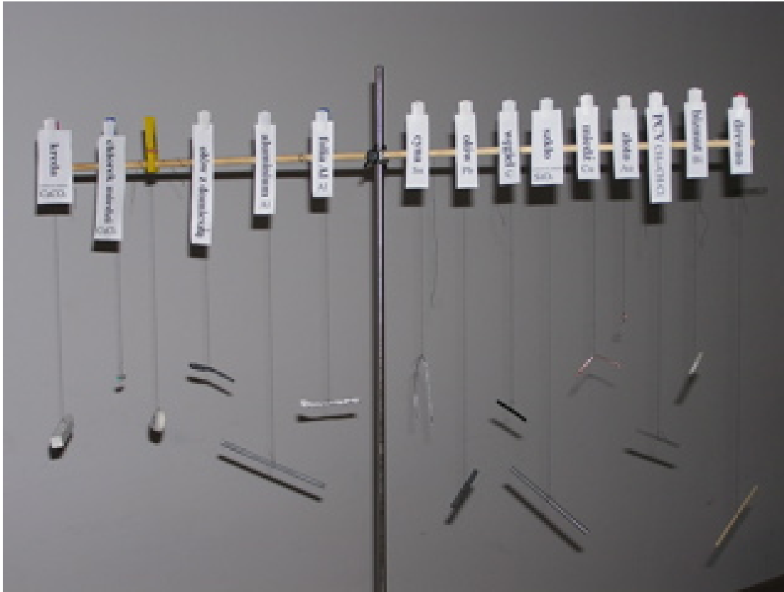
Zdj. 1. Na zdjęciu po lewej stronie pionowego pręta są paramagnetyki: kreda, chlorek miedzi, gumka, myszka, ołów z domieszką, pręt glinu, folia glinu a po prawej diamagnetyki: cyna lutownicza, ołów, węgiel, szkło, miedź, stop złota z miedzią, PCV, bizmut, drewno)
